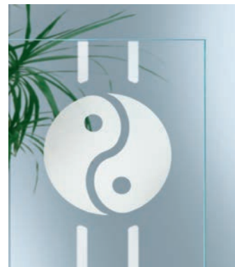
Bsp. Grundglas Float 4 mm klar Ausführung Motiv matt/Glas klar, gefertigt ab Werk ohne Oberflächenschutz, jedoch als Zusatzleistung bestellbar. Durch den Auftrag erhält die weisse sandgestrahlte Fläche ein dunkleres seidenmattes Aussehen, ähnlich dem Glas Satinato.
